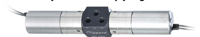
Estos circuitos para llenado y purga compactos son una combinación de válvulas electrónicas y manifolds que se usan para inflar y dejar salir aire o liberar presión en un sistema controlado. Estos circuitos se usan principalmente en aplicaciones en las que una presión, firmeza o posición particular se puede controlar con aumento o disminución de presión.
